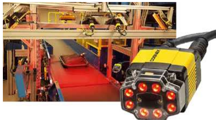
Soluzione ABH-ID di Cognex, basata sui lettori di codici a barre a gestione di immagini fissi della serie DataMan®, senza parti in movimento.
