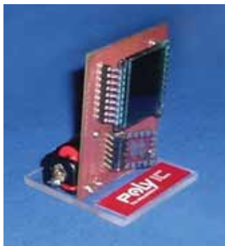
Prototype de machine avec écran, batterie et puce polymérique.
