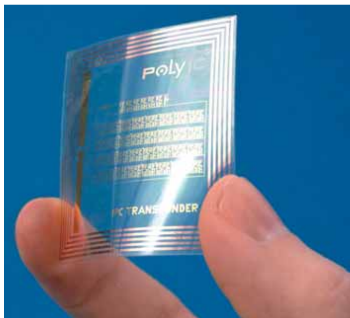
Puce imprimée sur pellicule en polyester avec de l'encre conductrice organique produite par PolyIC.
