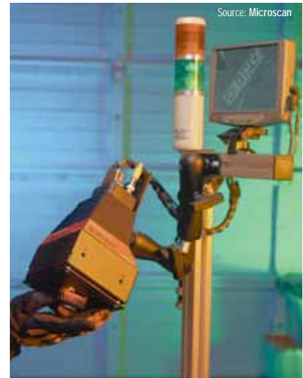
Source: Microscan Intégré ou en station autonome, un « vérificateur » valide instantanément la qualité d'un marquage DPMI.
